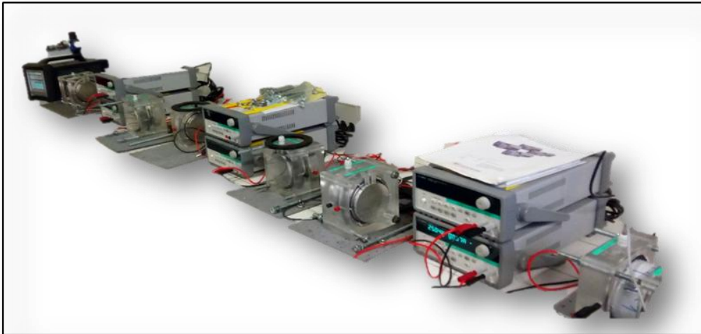
Figure 7 : Illustration du dispositif de mesure du coefficient de diffusion apparent des ions chlorure.
