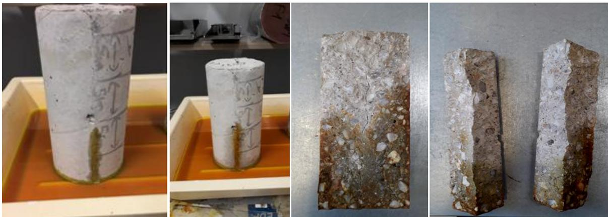
Figure 15 : Photographies de l'ascension de l'eau au sein du béton BO1 fracturé, avant et après fendage.
