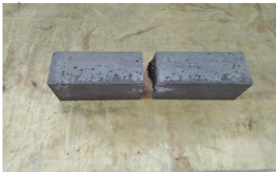
Fig. 9: Mortier sans fibre
