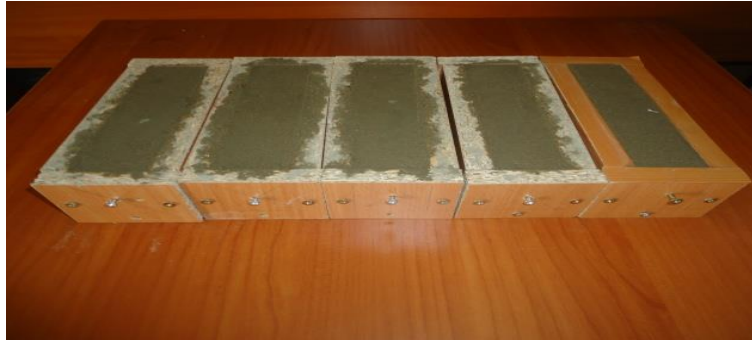
Fig 3. Coulage du béton de sable fibré de PP dans des éprouvettes de 40x40x160mm 3
