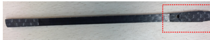
FIGURE 9 – Éprouvette orientée à 0° de [C_{10}] à rupture
