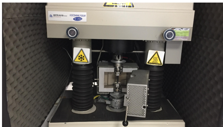
FIGURE 4 – Banc d'essais de la machine VA2000
