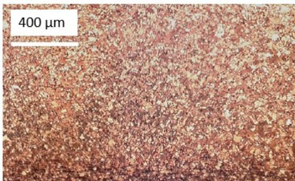
d) – microstructure sur la zone Z1 du joint pour la configuration Cu - 12
