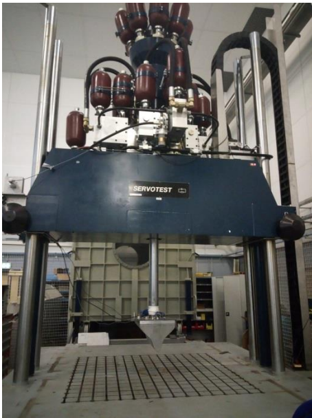
Fig 4: Photographie de la géométrie d'étrave suspendue au piston
