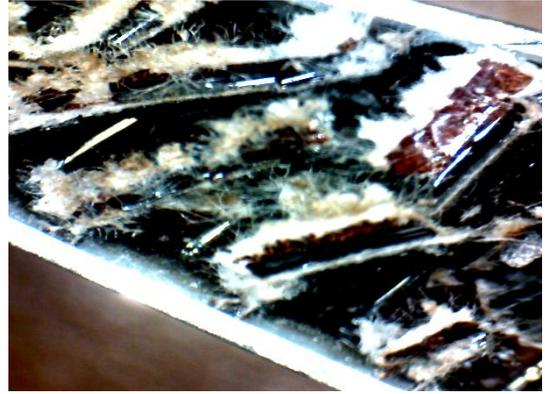
Fig. 3.18 : Cisaillement des parois de l'âme
