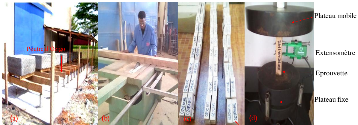
Fig. 1 : (a) Ambiance extérieur non abrité. (b) Sciage de la poutre. (c) Eprouvettes de compression du milieu extérieur non abrité (haute, médiane et basse). (d) Dispositif expérimental d'essai de compression
