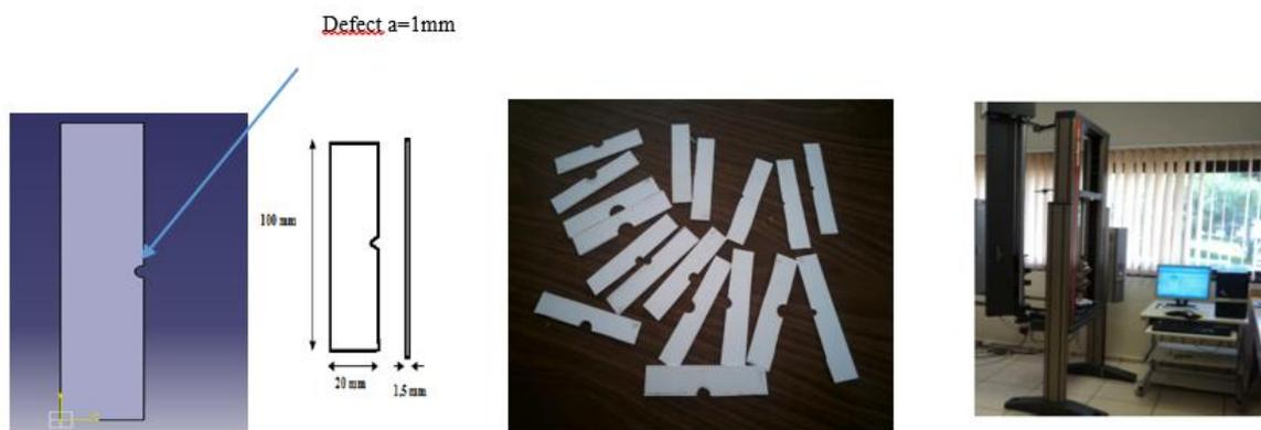
Figure 3 : (a) Dimensions de l'éprouvette ;(b) les différentes éprouvettes étudiés ; (c) Machine de traction type ZwickRoell
