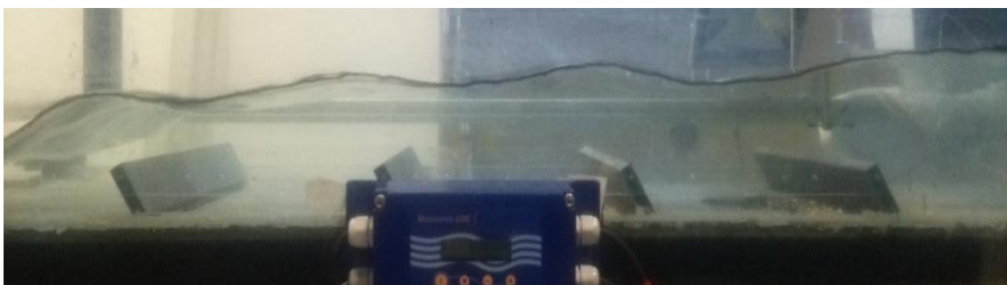
Figure 6 : Ecoulement dans le canal à courant du LOMC dans lequel on a introduit des riffles de 0.05m de hauteur et inter distant de 0.24m, débit=27 l/s par mètre de largeur, inclinaison: 53°
