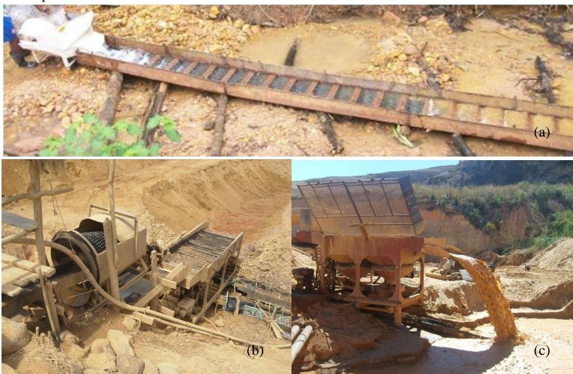
Figure 1-a): Sluice artisanal à Kianjavato, Sud-Est de Madagascar, b): sluice en bout de chaîne d'une unité de traitement de saphir à Bevilany (Madagascar), c) : sluice en bout de chaîne d'une unité de traitement de saphir à Ilakaka (Madagascar)
