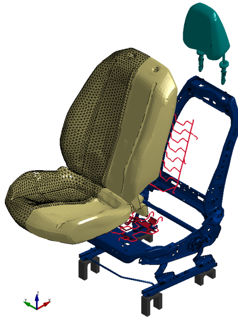
FIGURE 1 – Modèle éléments finis utilisé : Structure (bleu foncé), nappes de suspension (rouge), mousse (beige), coiffe (beige quadrillé, en coupe), appui-tête (bleu clair).
