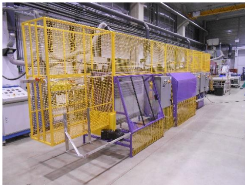
Figure 1. Dispositif d'extraction de fibres par teillage peignage Taproot
