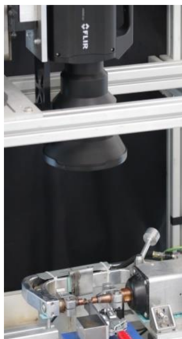
Figure 2.b : montage de la caméra au-dessus de la pince de soudage.
