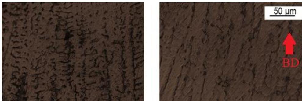
Figure 8. Micrographie d'une coupe transversale de mur, partie basse (gauche) et dernière couche (droite)
