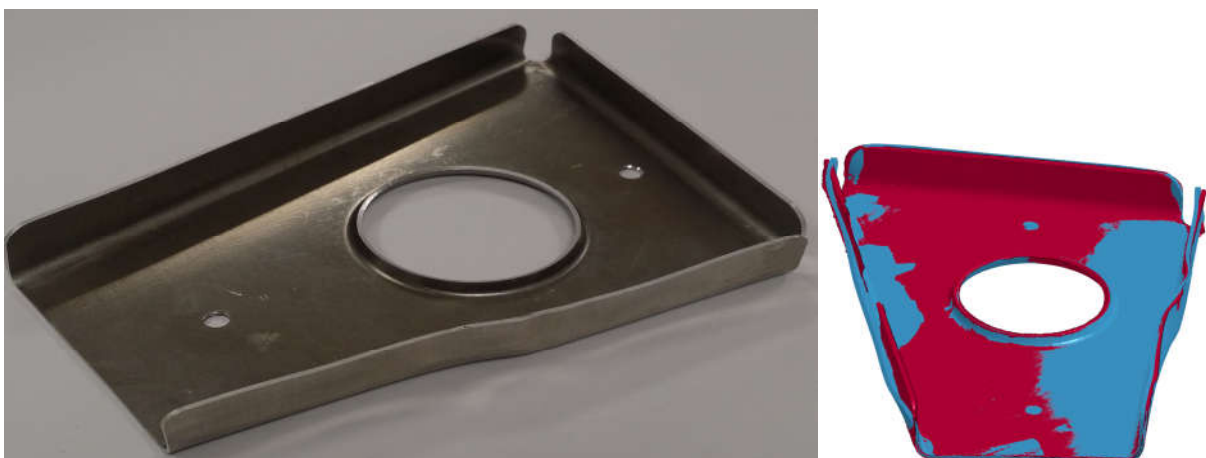
Figure 8 : formage magnétique d'une pièce échelle 1 / comparaison simulation avec le logiciel LS DYNA (en bleu) et pièce réelle (en rouge)
