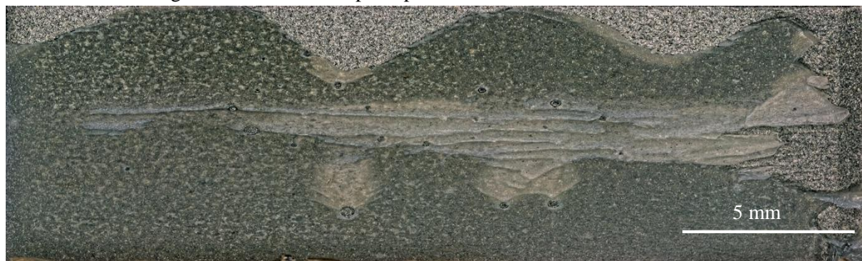
Figure 4.d : Faciès de rupture pour un refroidissement de 25°C/min:
