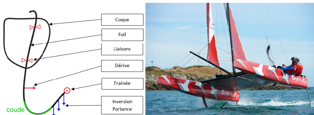
FIGURE 1 – Foil représenté schématiquement et les efforts apparaissant lors d'une utilisation en mer et d'une inversion de portance (cas critique)
