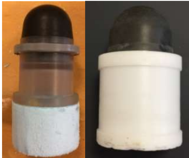
Figure 5: Gauche : sabot + projectile avec mousse au diamètre de 49.8 mm, masse totale 72 g environ. Droite : Sabot en POMC + projectile, masse totale 67 g environ.
