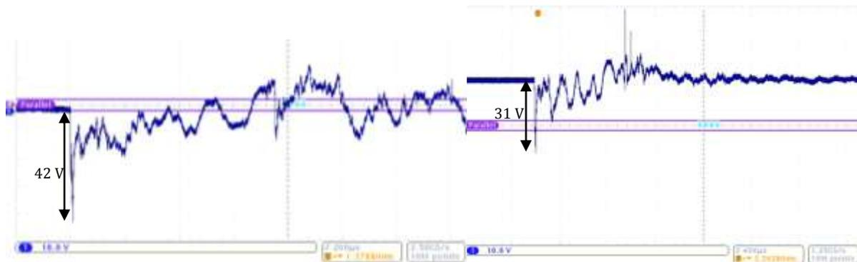
Figure 8 : Signaux bruts enregistrés par le capteur PVDF a) 1<sup>er</sup> tir à 10 cm, b) 2<sup>ème</sup> tir à 10 cm.
