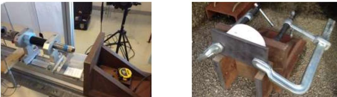
Figure 5 : a) disrupteur bridé sur le rail, face au porte cible (équerre), b) assemblage de la cible.
