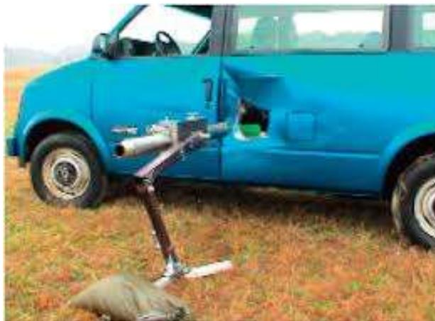
Figure 1 : Disrupteur ayant permis de neutraliser un colis suspect situé dans un véhicule.
