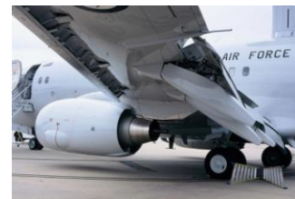
Figure 2 : Slats présents dans une aile d'avion [4]
