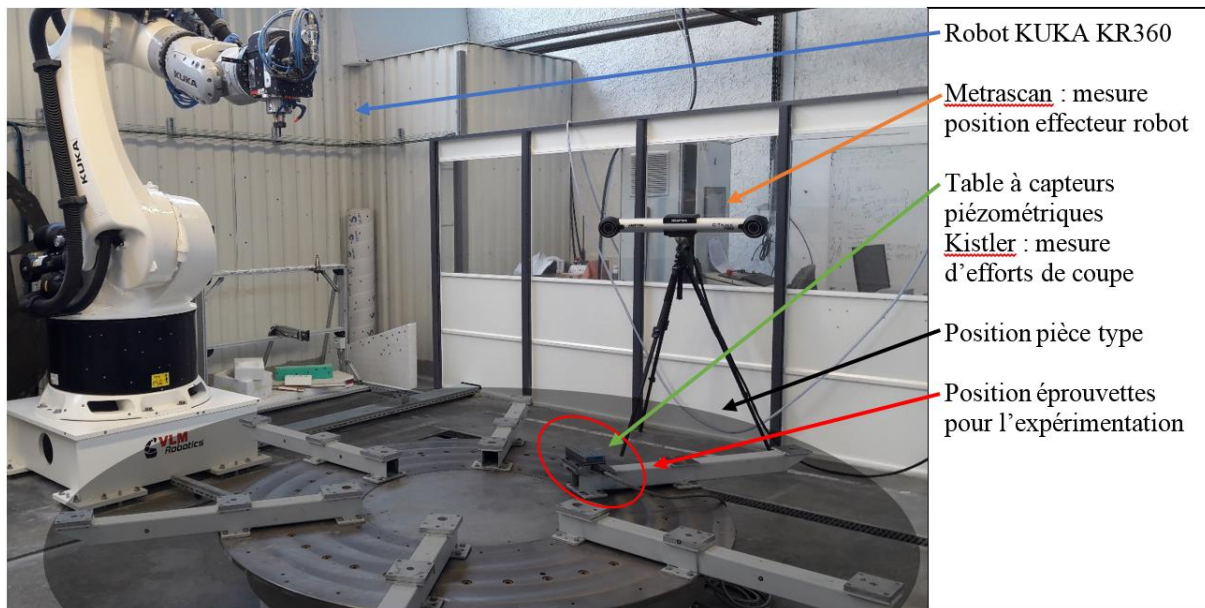
Figure 1: KUKA KR360 et moyens de mesure
