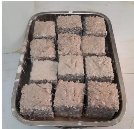
Figure 7 : éprouvettes des bétons immergées dans ( H_2SO_4 ).
