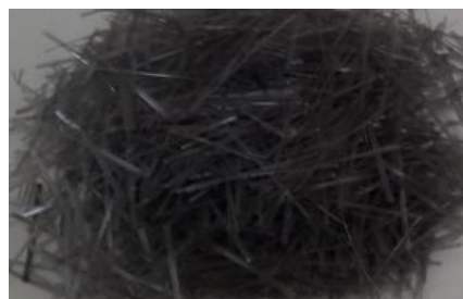
Figure 1 : Fibres polyéthylènes (longueur 50 mm)
