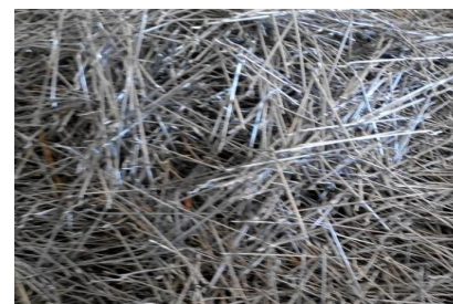
Figure 3 : Fibres métalliques (longueur 30 mm)
