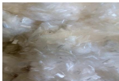
Figure 2 : Fibres polypropylènes (longueur 6 mm)
