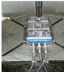
Figure.3. Dynamomètre et éprouvette d'essais en position incliné
